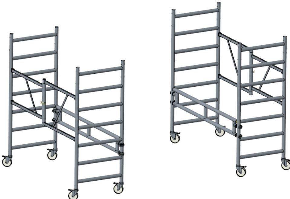
3. Positionieren Sie eine Plattform mit der gleichen Länge wie der Rahmen und in der gewünschten Höhe auf die Sprossen des Foldy-Klapprahmens.
