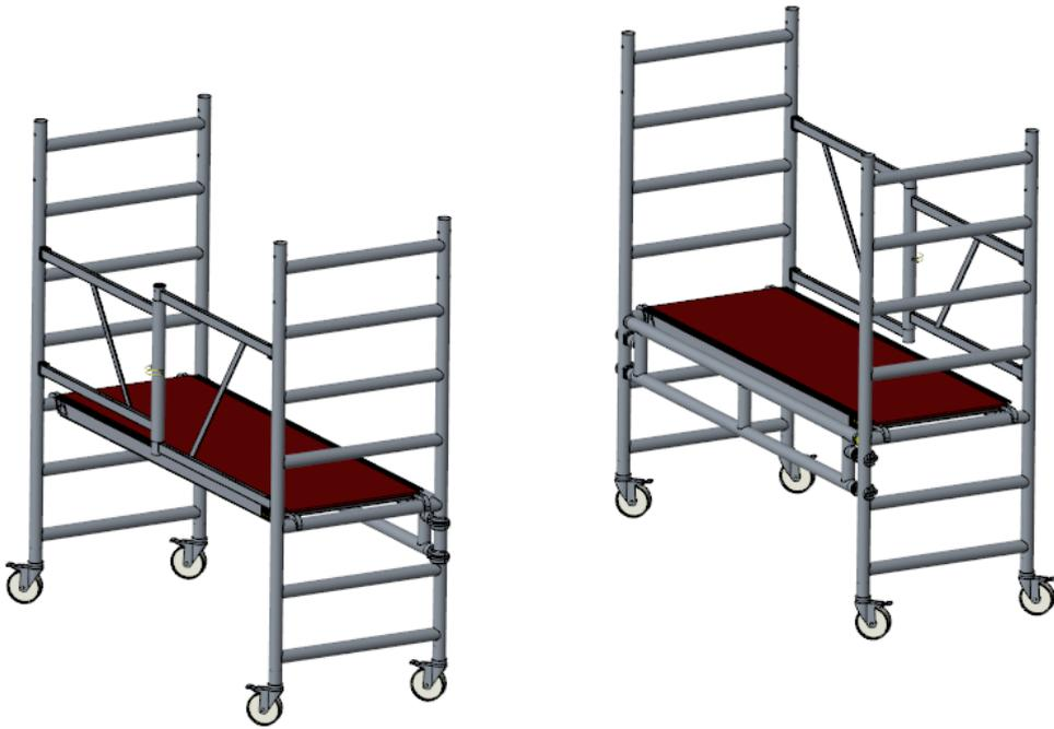
4. Platzieren Sie die restlichen Plattformen auf die Plattformträger der beiden Gerüste. Achten Sie darauf, dass alle Plattformen möglichst dicht beieinander liegen, auch die Plattformen der Foldy-Rahmen.
